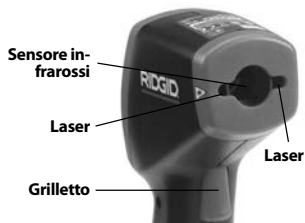
Figura 2 - Parti del micro IR-200
