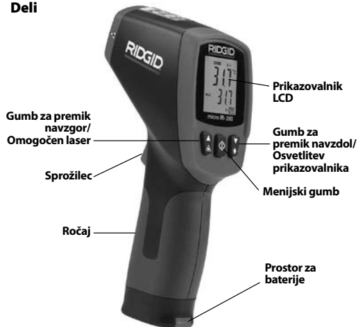
Slika 2 – Deli instrumenta micro IR-200
