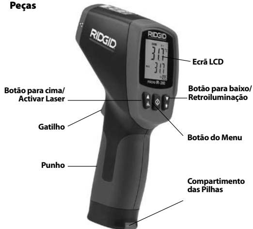
Figura 2 – Peças do micro IR-200
