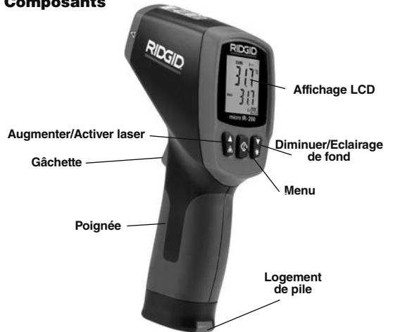
Figure 2 – Composants du micro IR-200
