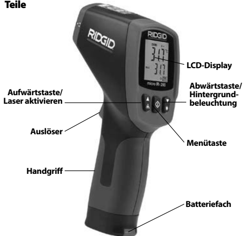
Abbildung 2 – Teile des micro IR-200
