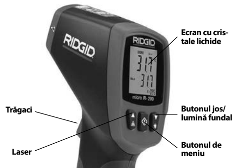
Figura 9 – Afișajul/butoanele aparatului micro IR-200
