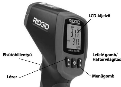
9. ábra – A micro IR-200 kijelzője/gombjai
