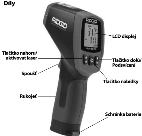
Obrázek 2 - Díly micro IR-200
