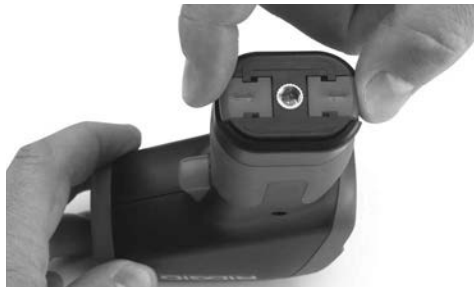
Figura 4 – Scoaterea compartimentului bateriei
