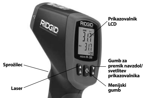
Slika 9 – Prikazovalnik in gumbi instrumenta micro IR-200
