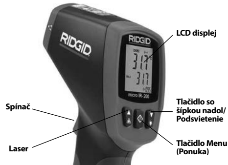
Obrázok č. 9 – Tlačidlá/Displej prístroja micro IR-200
