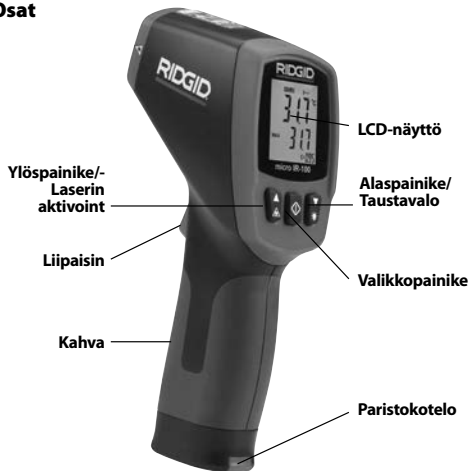
Kuva 2 – micro IR-200:n osat
