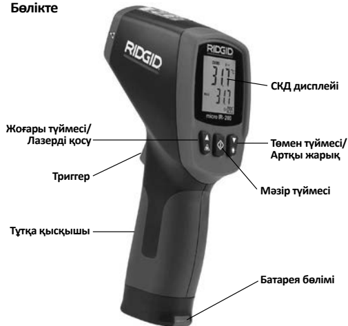
2-сурет – micro IR-200 бөліктері
