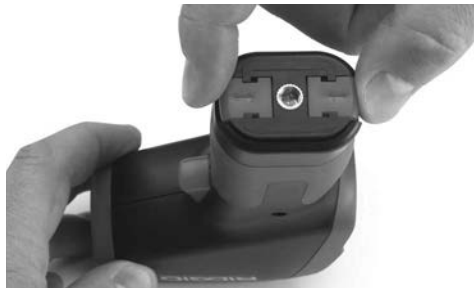
Slika 4 – Skidanje odeljka za baterije
