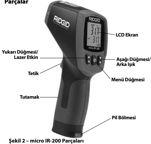
Şekil 2 - micro IR-200 Parçaları
